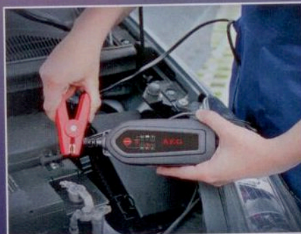
Die Klemmen des Ladegeräts sollten direkt an den Batteriepolen befestigt werden
