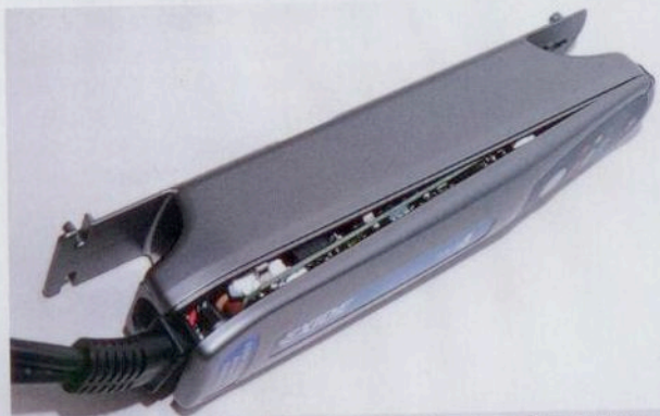
Beim Falltest unter winterlichen Bedingungen sprang das Gehäuse des Exide 12/4A auf und legte dabei die Elektronik frei
