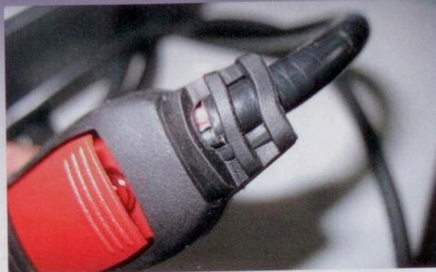
Unter Zuglast kann der Knickschutz an der Kabelklemme nachgeben. Die Folge könnte ein gefährlicher Kabelbruch sein
